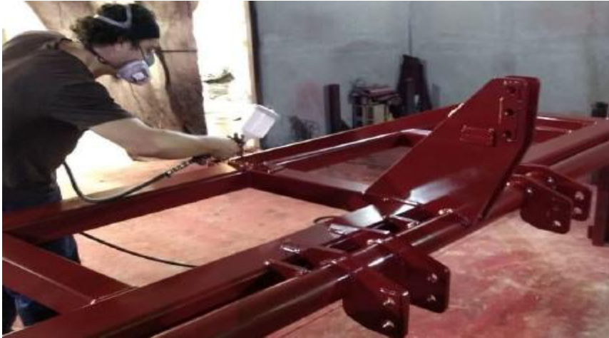
Ilustración 27 Aplicación de pintura en bastidor de arado
