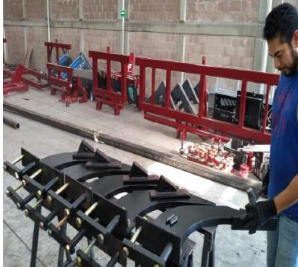
Ilustración 12 Acoplamiento de partes con herramientas manuales.
